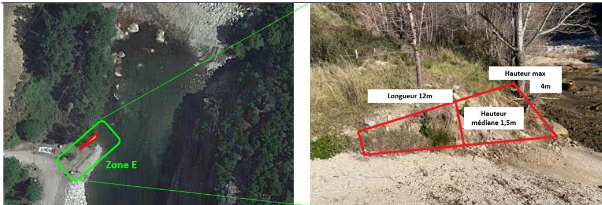
Figure 13: vue de la zone E et de l'implantation des enrochements
